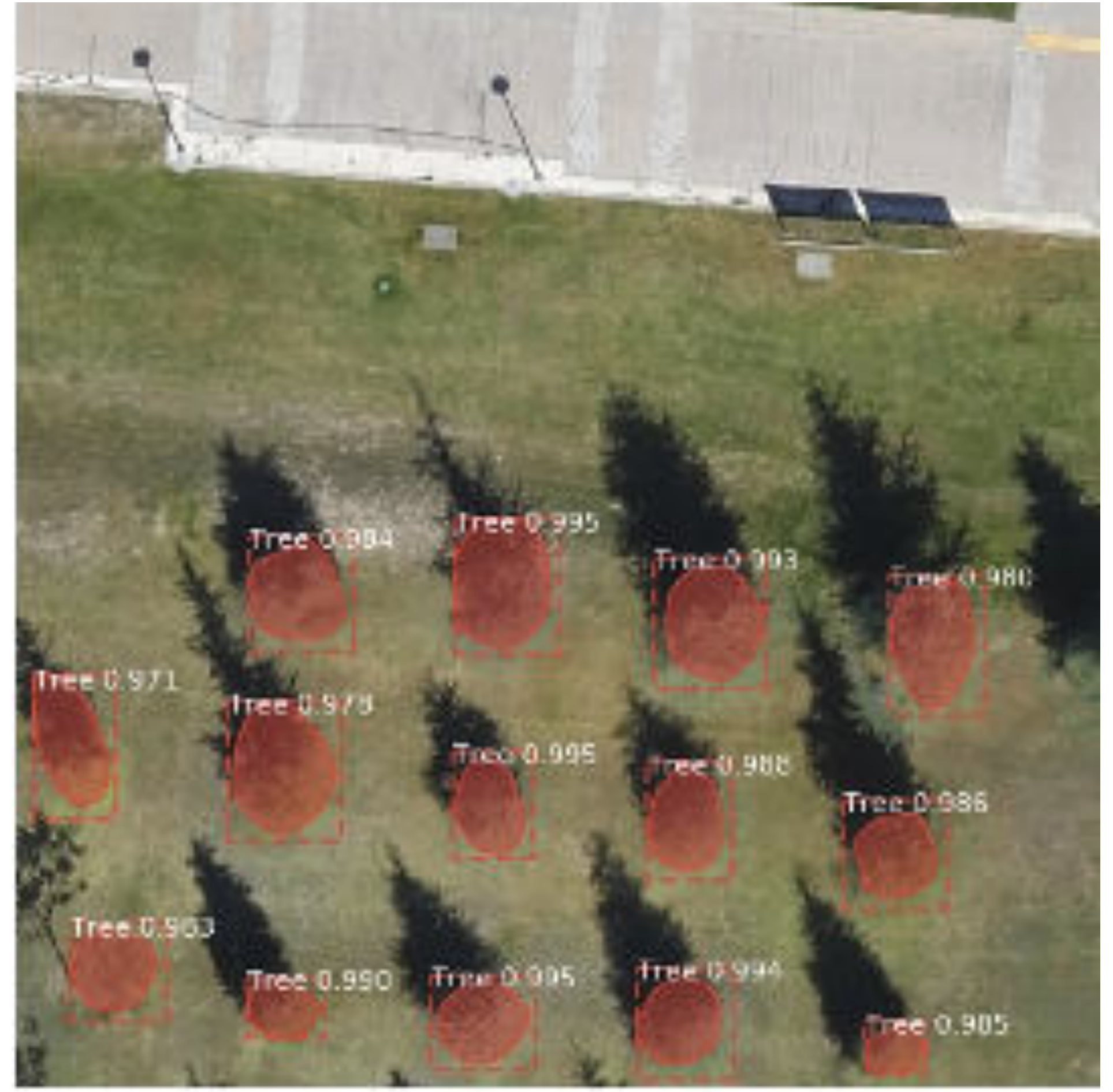
İnsansız Hava Aracı görüntülerinden derin öğrenme algoritmaları kullanarak otomatik ağaç sayımı çalışması
