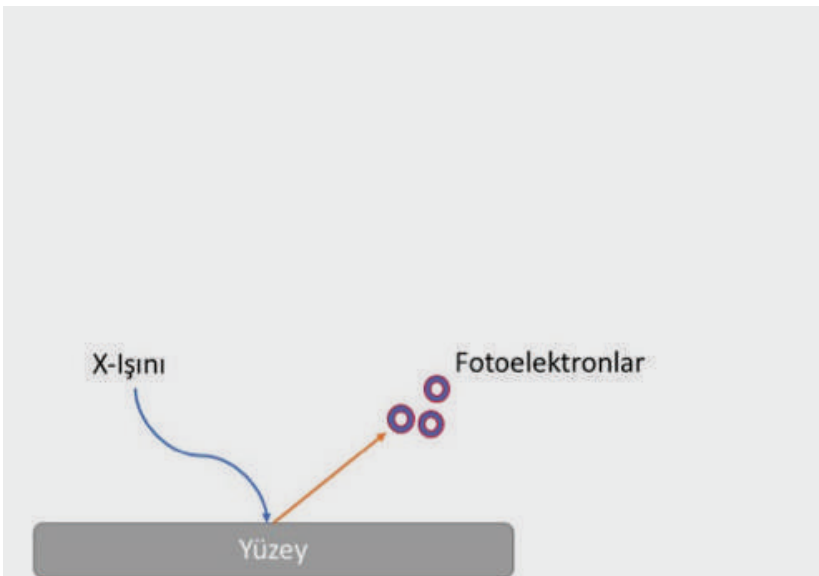
Şekil 1. Fotoelektronların yüzeyden ayrılması ve XPS cihazının şematik gösterimi
