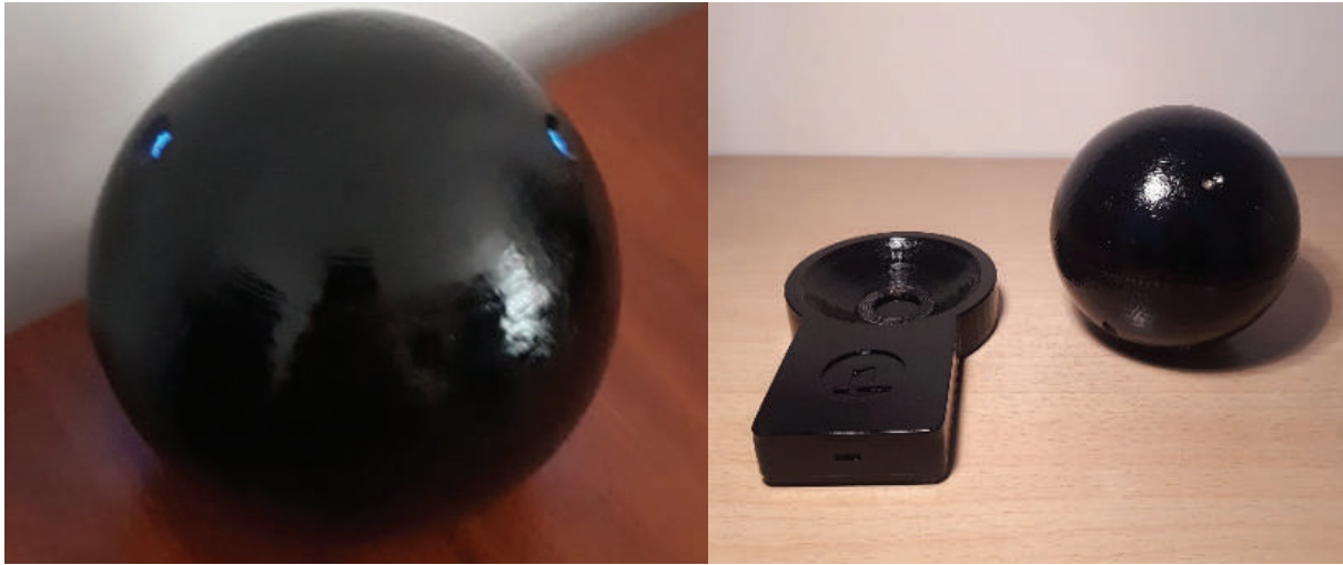
Şekil 1. 3D tasarlanmış top ve şarj ünitesi, Top içerisine yerleştirilen baskı devre kartı, Üretilmiş prototip UV-C Temizleyici Top
