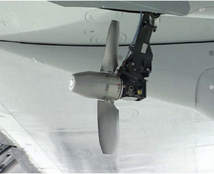
A330 Sağ Kanat Altından Düşen Ram Air Turbine
